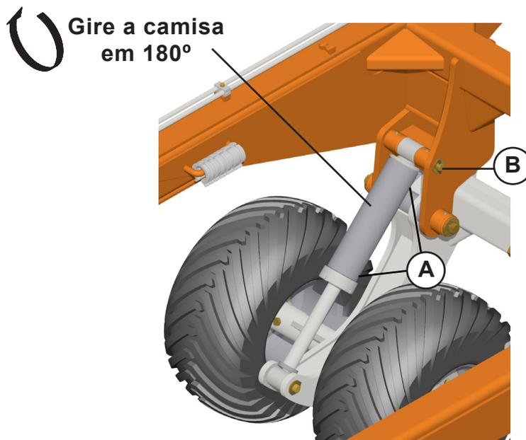
Em seguida faça a movimentação de 180°, deixando os terminais (A) virados para cima.
