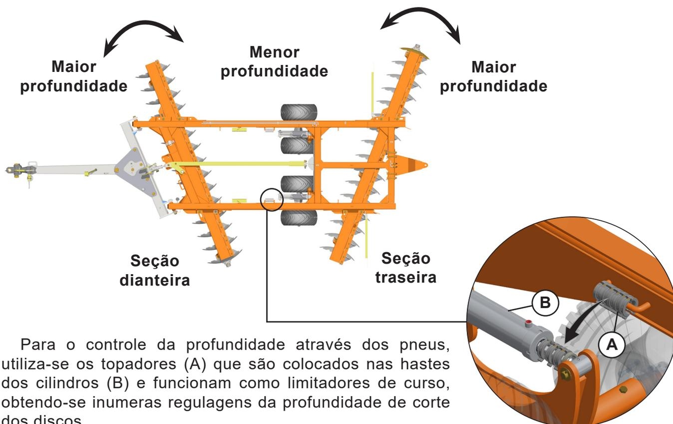
Para o controle da profundidade através dos pneus, utiliza-se os topadores (A) que são colocados nas hastes dos cilindros (B) e funcionam como limitadores de curso, obtendo-se inúmeras regulagens da profundidade de corte dos discos.
