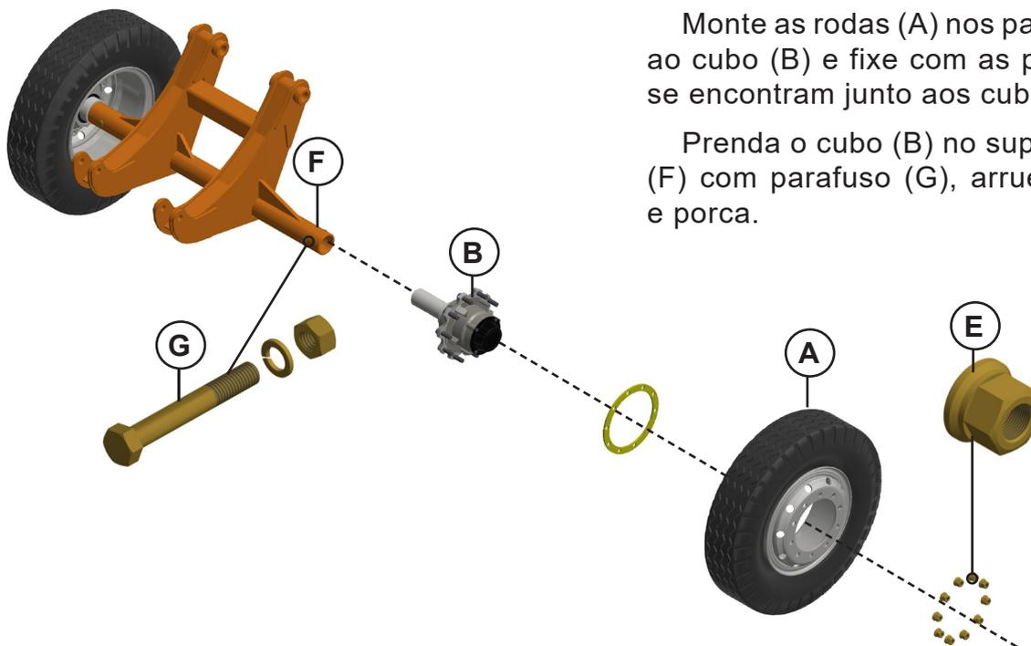
Monte as rodas (A) nos parafusos presos ao cubo (B) e fixe com as porcas (E), que se encontram junto aos cubos.
