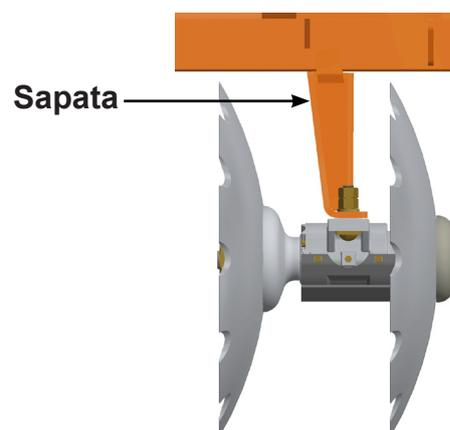
Coloque o parafuso (A), passando pela caixa do mancal (E) e pelo orifício da sapata (F); por cima coloque arruela lisa (B) e (C), porca e contraporca (D).
