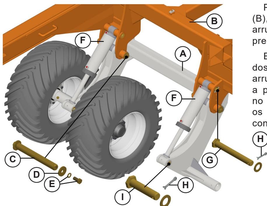
Prenda o rodeiro (A) no quadro (B), usando o eixo de junção (C), arruelas lisas (D), arruelas de pressão e parafusos (E).
